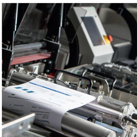
überwacht. Mit der zusätzlichen Papierlaufüberwachungssensorik wird eine maximale Verarbeitungssicherheit und -kontrolle gewährleistet.
