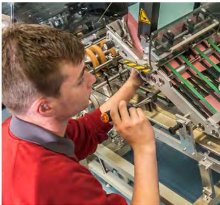
Die jüngste Entwicklung im Bereich Verpackungslösungen ist das PackOn-Time 2box Multiformat-Verpackungssystem. Dies operiert mit nachhaltigem Recyclingkarton und macht zusätzliche Füllmaterialien wie Plastik, Luftpolsterfolie, Styropor usw. überflüssig. Bestellungen aller Art (Einzel- und Mehrfachartikel) werden im 3D-Verfahren vermessen und danach in die passgenaue Verpackung eingelegt.
